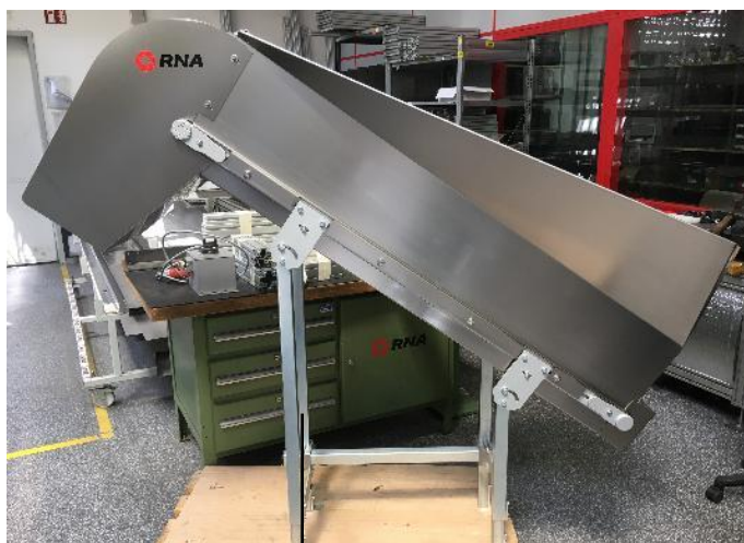
1 Bâti en profilés tubulaires, acier zingué
